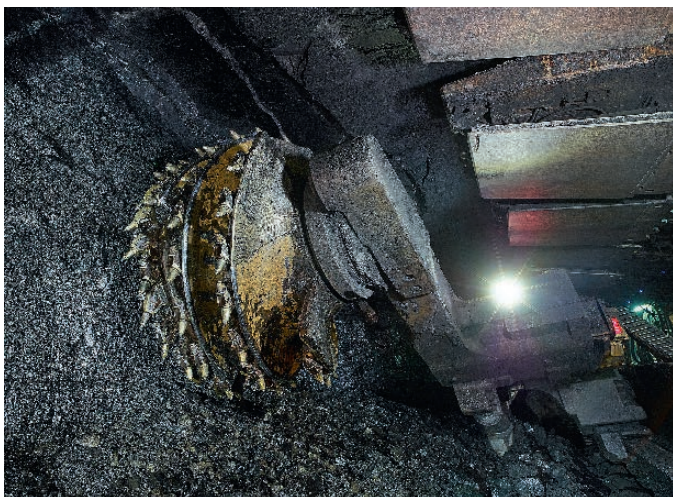
Fig. 4. Shearer loaders and shield supports were operated for years without mineral oil-based hydraulic fluids in the German hard coal mining industry. // Bild 4. Walzenlader und Schildausbau wurden im deutschen Steinkohlenbergbau jahrelang ohne Hydraulikflüssigkeiten auf Mineralölbasis betrieben. Photo/Foto: RAG
