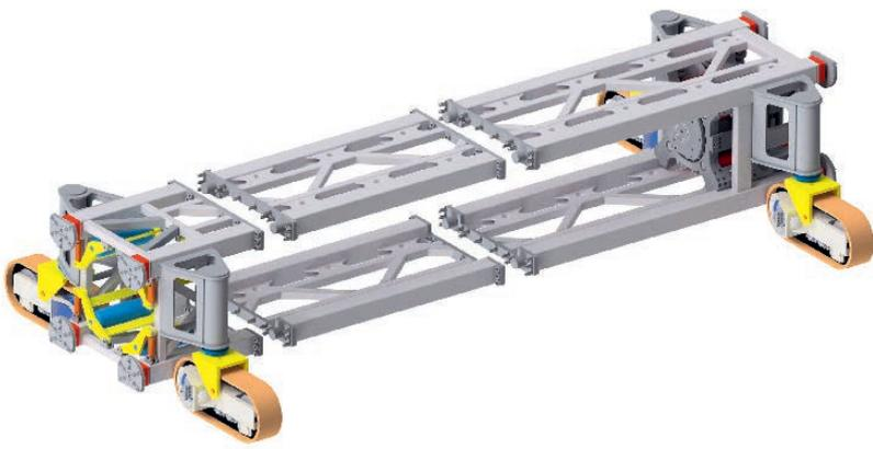
Fig. 6. Test machine for testing different drilling tools. // Bild 6. Testmaschine zur Erprobung verschiedener Bohrwerkzeuge. Source/Quelle: Perforator
