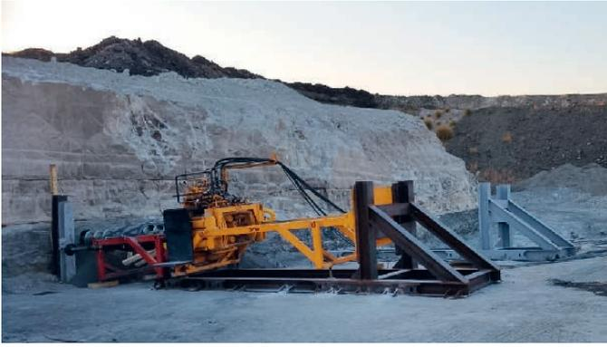
Fig. 1. Test drilling with a thrust boring machine, type PBA155, in South Africa. // Bild 1. Testbohrungen mit einer Pressbohranlage, Typ PBA155 in Südafrika. Photo/Foto: Perforator
