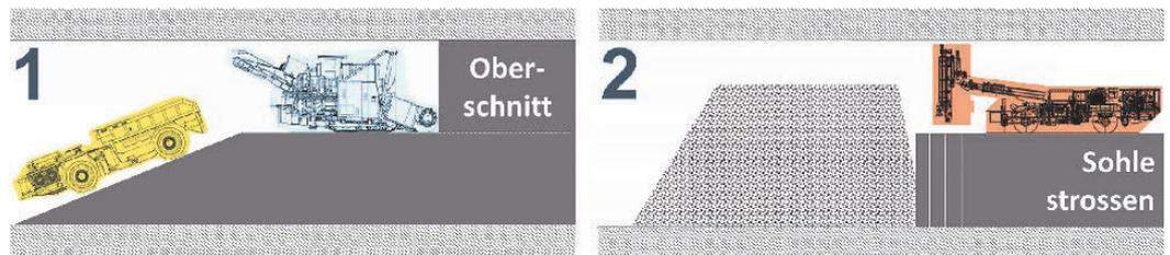
Fig. 7. Schematic diagram showing the excavation of the deposits by continuous miner in the top cut and by drilling and firing in the lower levels. // Bild 7. Schematische Auffahrung der Lagerstätte mit Continuous Miner im Ober-schnitt und sprengtechnischer Gewinnung der unteren Ebene. Source/Quelle: SSW
