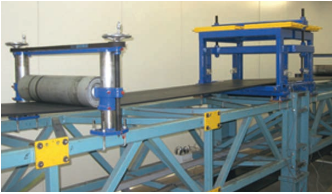
Fig. 9. Belt indentation rolling resistance test facility. Bild 9. Testanlage für Eindruckrollwiderstand. Source/Quelle: tk
