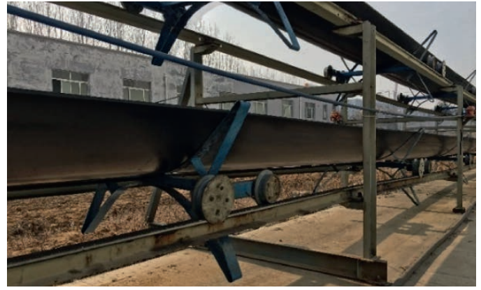
Fig. 5. Conveying section of prototype system with carry side above. Bild 5. Detailansicht des Prototyps mit Tragseite oben. Source/Quelle: tk
