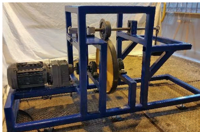
Fig. 12. Laboratory test equipment to measure track wheel wear and friction. // Bild 12. Testaufbau für Felgenwiderstand in Kombination zur Kontaktreibung. Source/Quelle: tk
