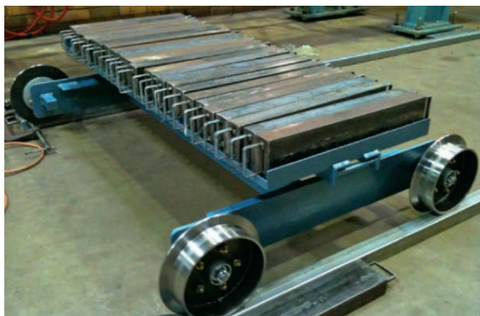
Fig. 11. Laboratory test equipment to measure rolling resistance. Bild 11. Testaufbau für Laufradwiderstandsmessungen. Source/Quelle: tk
