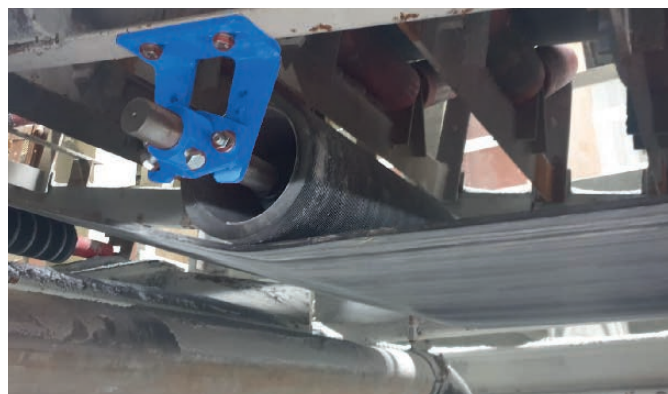
Fig. 2. The belt tracker as the basic system of the E-PrimeTracker can be easily installed in existing conveyor systems. // Bild 2. Die Lenkrolle als Basissystem des E-PrimeTrackers lässt sich einfach in bestehenden Förderanlagen installieren. Photo/Foto: ScrapeTec
