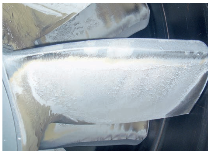
Fig. 8. Impeller conveying dust. Bild 8. Flügelrad bei Staubbeförderung. Photo/Foto: Korfmann
