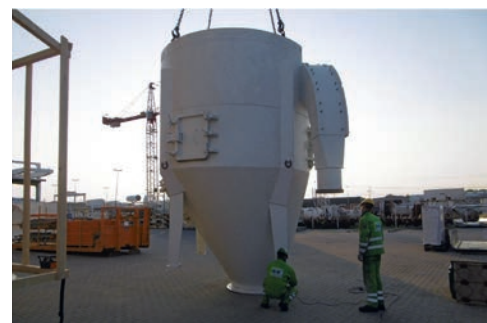
Fig. 3. Suction tank (cyclone) on WD 8. Bild 3. Saugtank (Zyklon) auf WD 8. Source/Quelle: Herrenknecht/Redpath Deilmann
