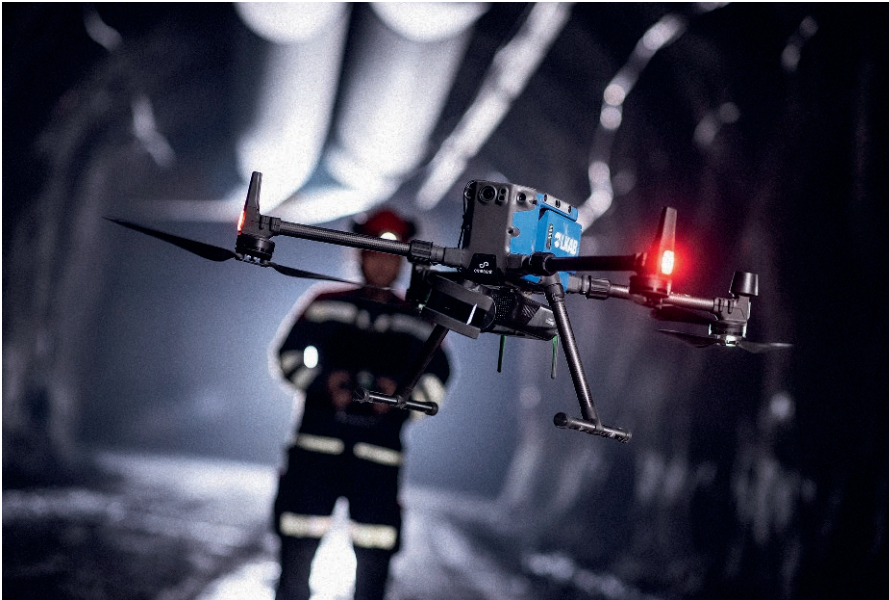
Fig. 1. Drone with operator scanning underground. Bild 1. Drohne mit Bediener beim Scannen unter Tage. Photo/Foto: LKAB, Frederic Alm
