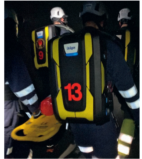
Fig. 2. The new Dräger BG ProAir breathing apparatus in use at LKAB in Sweden. Bild 2. Das neue Kreislaufatemschutzgerät BG ProAir von Dräger im Einsatz bei LKAB in Schweden. Photo/Foto: LKAB
