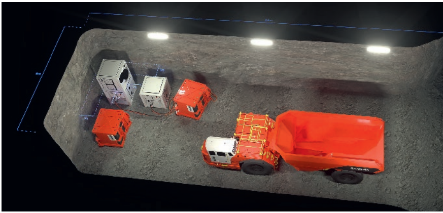
Fig. 4. Charging table with TH550B, two mobile charging stations, one mobile cooling unit. Bild 4. Ladenische mit TH550B, zwei mobilen Ladestationen, einer mobilen Kühleinheit. Photo/Foto: Sandvik
