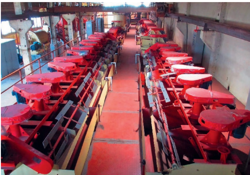
Fig. 8. Flotation cells of the pilot plant. Bild 8. Flotationszellen der Pilotanlage. Photo/Foto: SME
