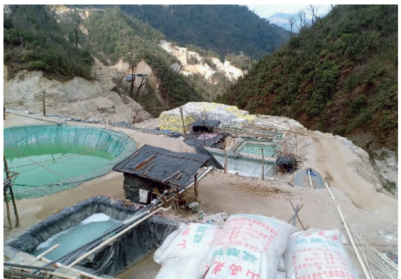
Fig. 2. In situ leaching at an rare earth mine in Myanmar near the Chinese border. Bild 2. In-situ-Laugung auf einem Seltenerd-Bergwerk in Myanmar nahe der Grenze nach China. Photo/Foto: Global Witness
