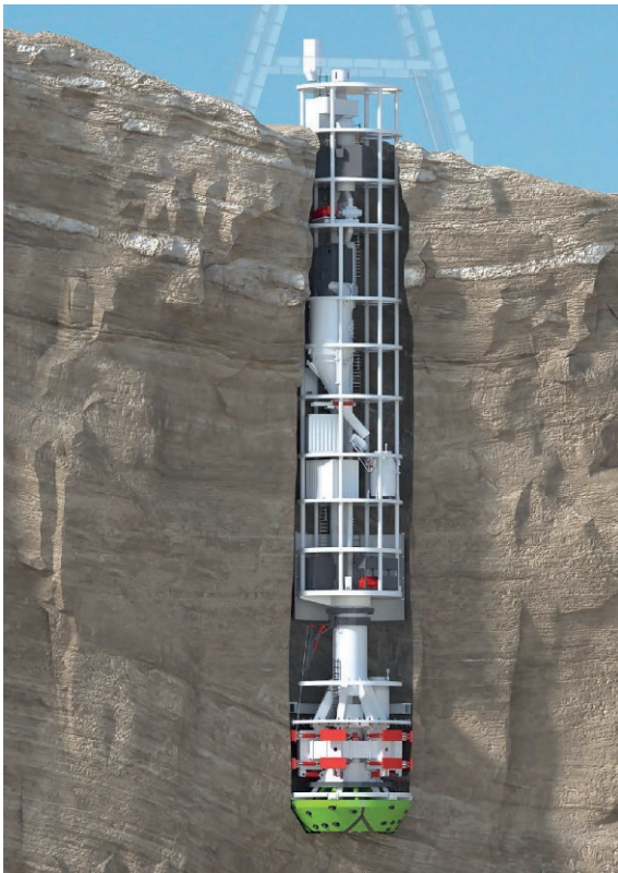
Fig. 4. // Bild 4. SBC – Shaft Boring Cutterhead. Source/Quelle: Redpath Deilmann
