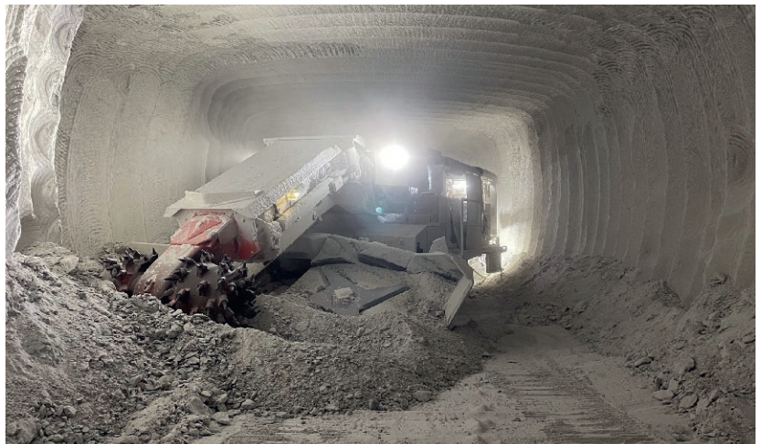
Fig. 2. Roadheading machine. // Bild 2. Teilschnittmaschine. Photo/Foto: SWS
