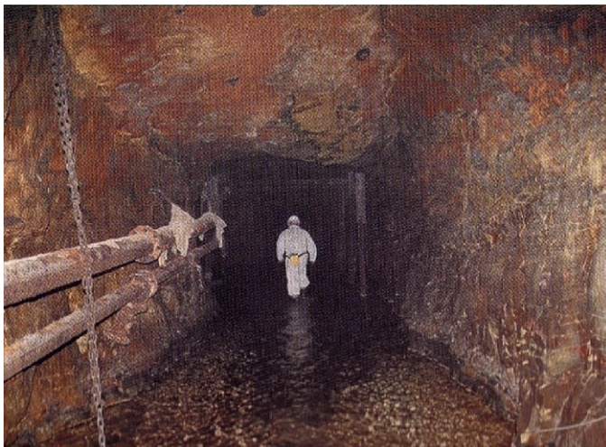
Fig. 4. Partially flooded mine tunnel at a gold mine in the Far West Rand. Bild 4. Teilweise gefluteter Stollen in einem Goldbergwerk im Far West Rand-Gebiet. Photo/Foto: Winde
