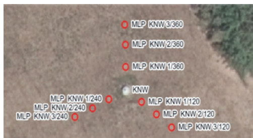
Fig. 8. Range determination: setting a grid to determine the negative pressure in the surrounding area. Bild 8. Reichweitenbestimmung: Setzen eines Rasters zur Bestimmung des Unterdrucks im Umfeld. Source/Quelle: THGA
