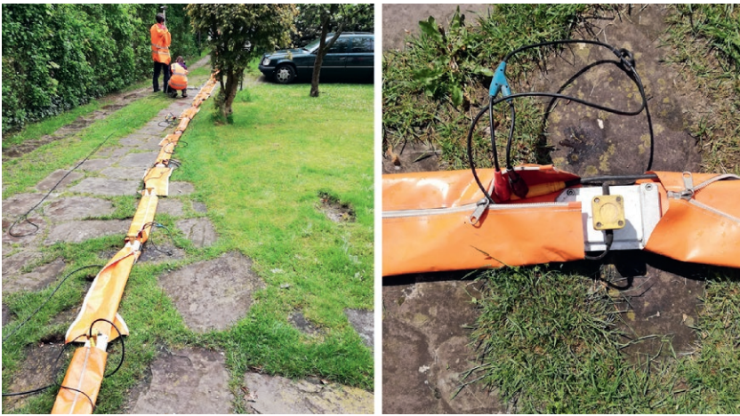
Fig. 3. Landstreamer on sealed surface (left), geophone (right). Bild 3. Landstreamer auf versiegelter Oberfläche (links), Geophon (rechts). Photos/Fotos: Weinbach
