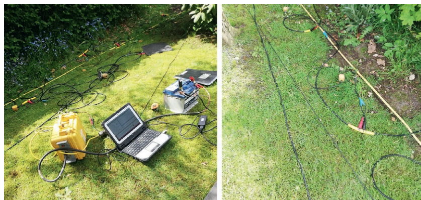
Fig. 2. Use of the measuring devices (left) and plug-in geophones (right). Bild 2. Einsatz der Messgeräte (links) und Steckgeophone (rechts). Photos/Fotos: Weinbach
