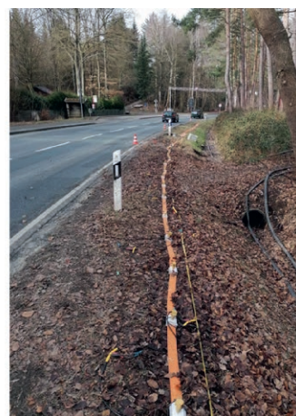
Fig. 1. Location of the test profiles along the Emmetal road (left), display of the landstreamer (right). Bild 1. Lage der Testprofile entlang der Straße Emmetal (links), Auslage des Landstreamers (rechts). Photos/Fotos: Weinbach
